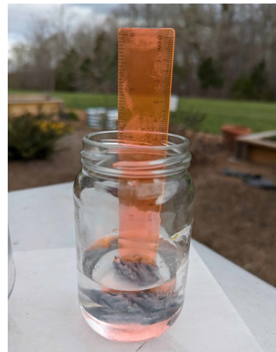
Pluviómetro alternativo para medir a precipitação (frasco de vidro e régua)
